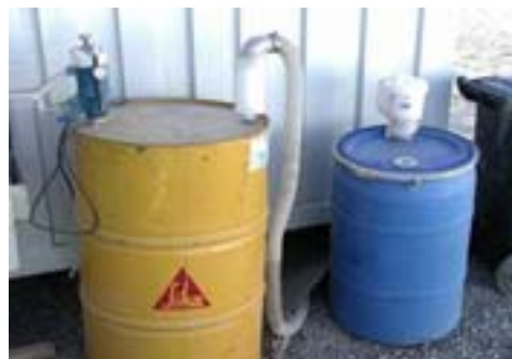
Foto 13. Sistema de limpieza de envases de WD-40 en Minera Escondida Limitada.
