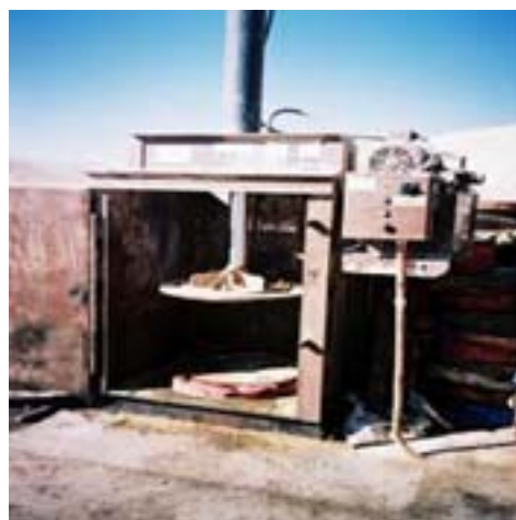
Foto 14: Compactador de tambores utilizado en Minera Escondida.
