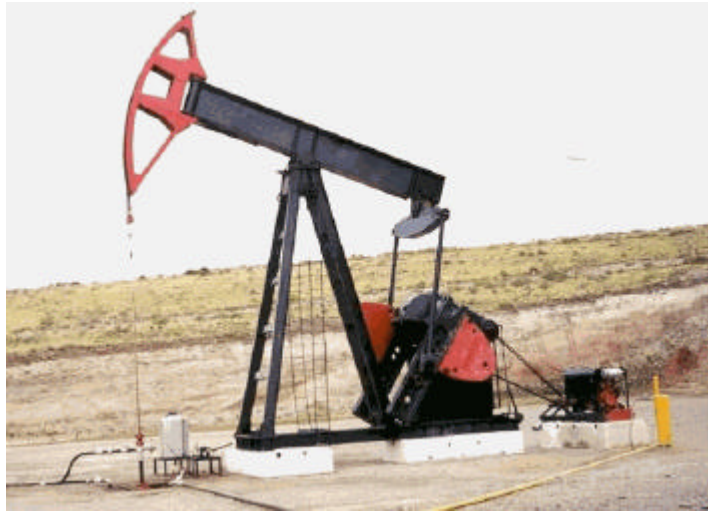
Fig. 2- El bombeo mecánico es el medio de extracción artificial más usado en Argentina.
